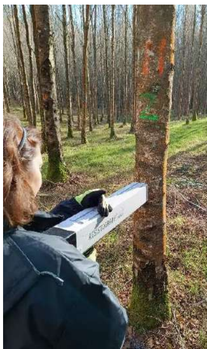
Medida resistográfica parcela de Bóveda. Resistógrafo Modelo 4453-S (Rinntech).
