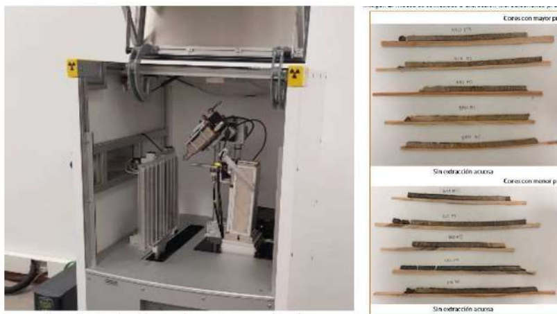
Figura 6. Microdensitómetro de rayos X, Itrax multiscáner
